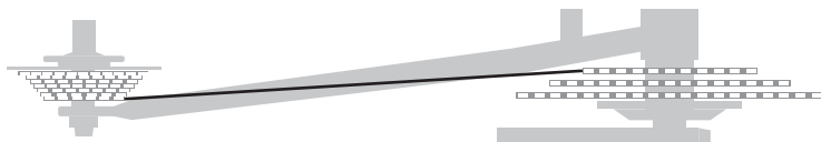
Łańcuch prowadzony od małej zębatki do małej zębatki
